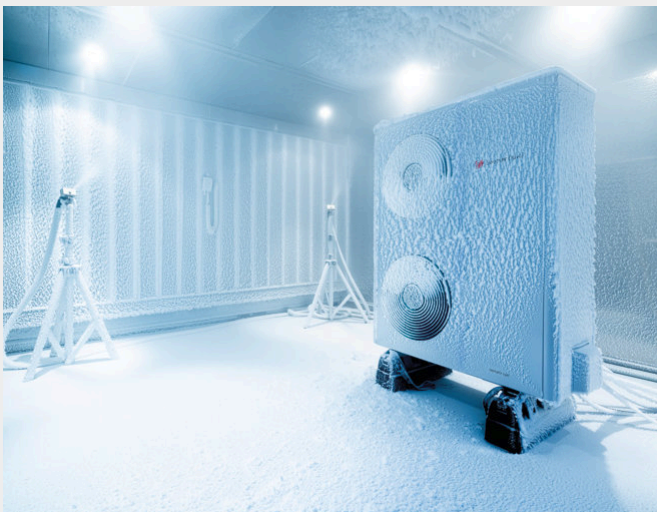
La resistencia a condiciones meteorológicas extremas se prueba ampliamente en nuestra cámara climática.
